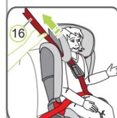
6. Insérez la ceinture diagonale (16) dans le support de sangle rouge foncé (01) de l'appui-tête (22) jusqu'à ce qu'elle repose complètement et sans être torsadée dans le support de sangle (01).
