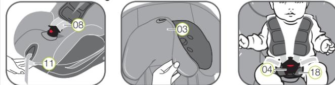
1. Drücken Sie den Neigungsverstellhebel 11 nach oben und schieben Sie die Sitzschale 17 nach hinten in die aufrechte Position.
