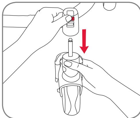
Drücken Sie zum Abnehmen der Vorderräder auf den Entriegelungsknopf und nehmen Sie das Rad ab
