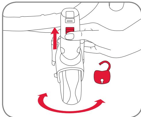
Az első görgő rögzítésének feloldásához nyomja felfelé a görgő rögzítő-gombját, ekkor a kerekek szabadon foroghatnak.
