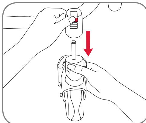
для снятия передних колес нажмите на кнопку снятия колеса и снимите его
