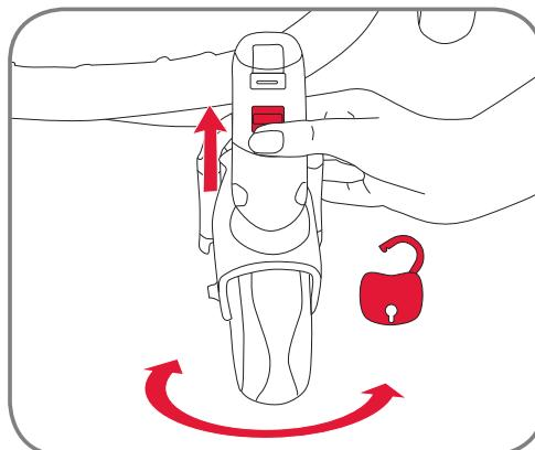
Для снятия замка поворотного переднего колеса нажмите на кнопку замка вверх, и колеса будут сами поворачивать.
