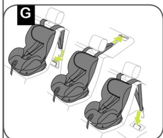
9. Engate o gancho de encaixe 26 no ponto de ancoragem do Top Tether (Cinto superior) recomendado no seu guia de utilizador do veículo.
