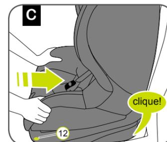
4. Segure o assento de segurança para crianças com as duas mãos e deslize os dois braços de fixação 17 firmemente nos apoios de engate 02 até que os braços de fixação encaixem com um clique sonoro de ambos os lados.
