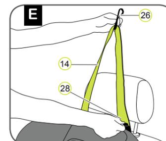
7. Pegue no Top Tether (Cinto superior) 14 e pressione a lingueta de metal 28 afastando-a do cinto para alongar o cinto e puxar o Top Tether (Cinto superior) 14 pelo gancho de encaixe 26 até obter um alinhamento em V.
