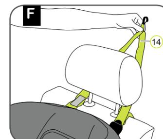
8. Passe o Top Tether (Cinto superior) 14 pela esquerda e pela direita do apoio para a cabeça.
